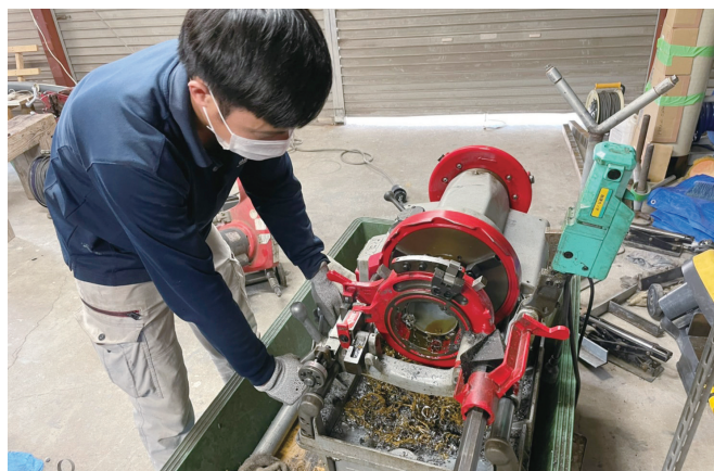
旋盤でパイプにねじを切り込む作業をするトワ
